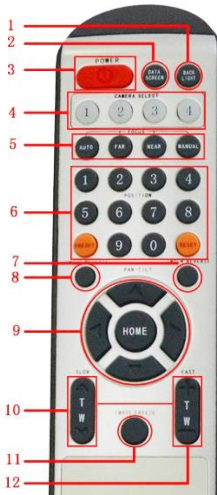
(оранжевая кнопка слева) и затем одну из цифровых кнопок. Будет сохранен 1-й пресет. Кнопками управления панорамированием, наклоном и зумом измените положение и увеличение камеры. Снова нажмите "PRESET" и другую цифровую кнопку. Будет сохранен следующий пресет. Продолжая эти действия до кнопки "0", можно сохранить в памяти камеры 10 пресетов.
