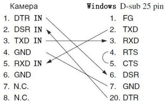
Подключение камеры к 25-ти контактному интерфейсу RS-232
