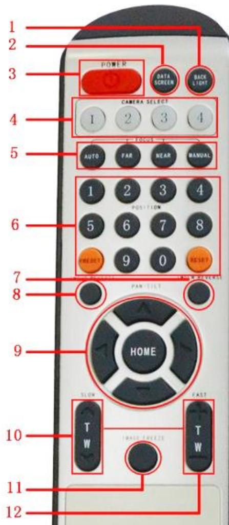
(оранжевая кнопка слева) и затем одну из цифровых кнопок. Будет сохранен 1-й пресет. Кнопками управления панорамированием, наклоном и зумом измените положение и увеличение камеры. Снова нажмите "PRESET" и другую цифровую кнопку. Будет сохранен следующий пресет. Продолжая эти действия до кнопки "0", можно сохранить в памяти камеры 10 пресетов.
