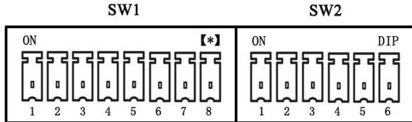
Установка адреса камеры при помощи DIP-переключателя SW1.
