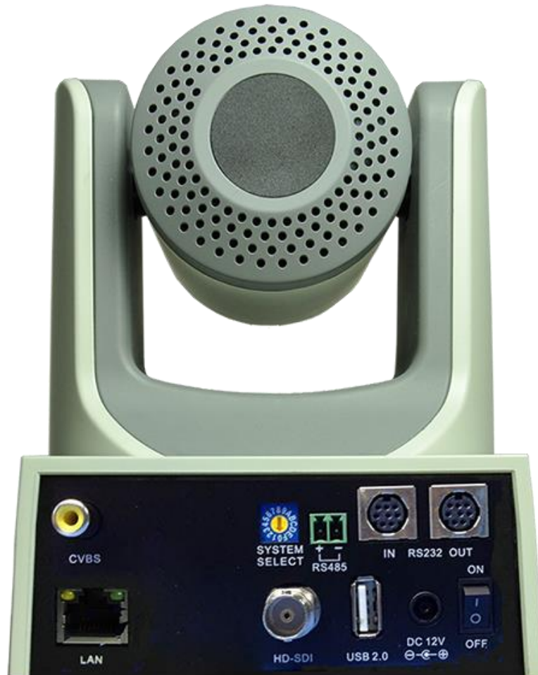
Вид камеры Prestel HD-PTZ2IP со стороны разъемов
