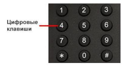
1. Для создания предустановленной позиции необходимо нажать клавишу: 【SET PRESET 】 и затем нажать одну из цифровых клавиш: 0-9, для запоминания соответствующей позиции. Можно настроить максимально 10 предустановленных позиций.
